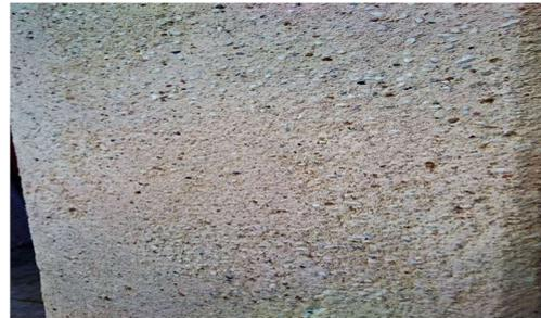
**COMPOSIZIONE:** Calce idrata fiore, Inerte di marmo, Inerte siliceo, Calce idraulica naturale, Cocciopesto di mattone ad impasto molle.
