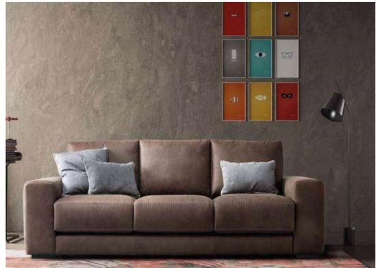
**COMPOSIZIONE:** Micro-calce idrata bianca, argille crude e calcinate, carbonato calcareo purissimo, eventualmente con aggiunta di cocchiopesto micronizzato nelle tonalità del giallo.
