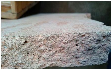
**IMPIEGO:** Come massetto, formato da uno strato monolitico di almeno 40 mm, per il riempimento e livellamento su solai di legno, solai in cemento e latero-cemento. Particolarmente indicato per la posa di pavimenti radianti. Una volta maturato supporta pavimenti seminati alla veneziana, rivestimenti in cotto, pavimenti di legno posati a colla o inchiodati su magatelli.
